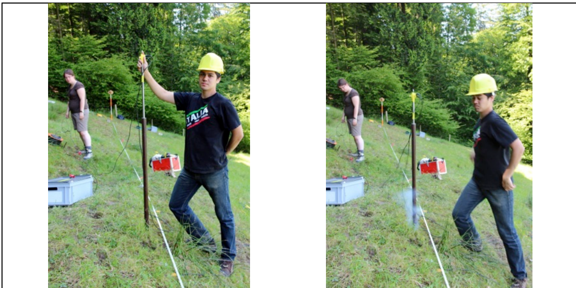
Abbildung 2: „Shot gun“ im Einsatz: Eine B llerpatrone wird in einem Stahlrohr in etwa 0.5 bis 1 m Tiefe gez ndet.
