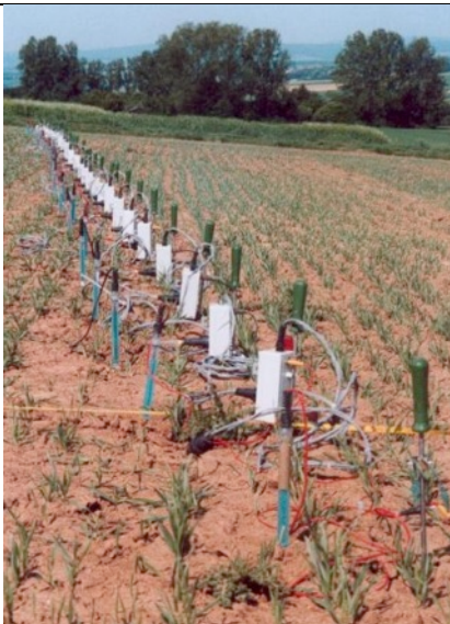
Abbildung 5: Geoelektrische Auslage mit Elektroden (Metallspieße) und Kabeln.
