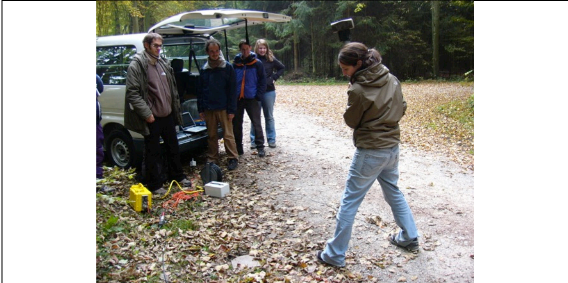
Abbildung 1: Hammerschlagsseismik: Mit einem 5 kg Hammer wird auf eine Metallplatte geschlagen um elastische Wellen anzuregen.
