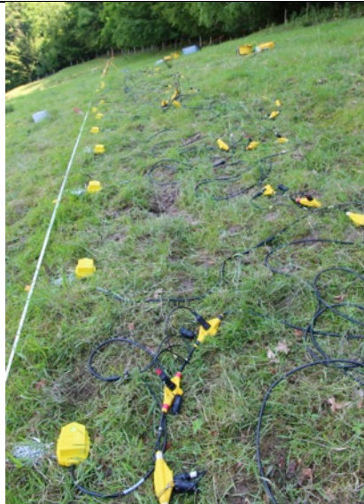
Abbildung 4: Auslage von Geophonen (Gelbe Boxen).
