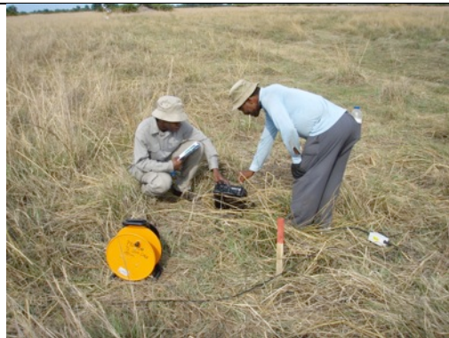
Abbildung 5: Geoelektrische Auslage mit Elektroden (Metallspieße) und Kabeln.
