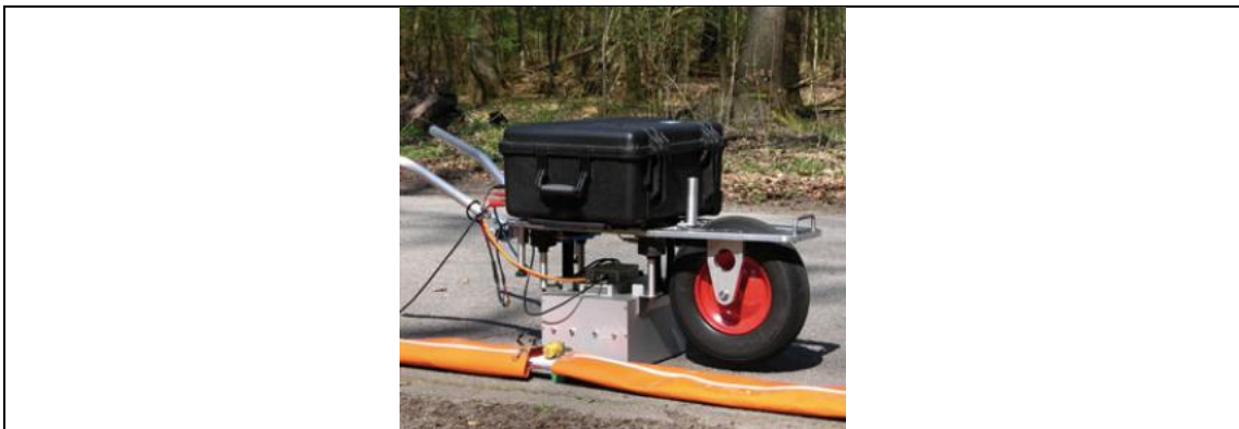
Abbildung 3: ELVIS Mini-Vibrator auf einer Schubkarre zur Anregung von Vibrationen.
