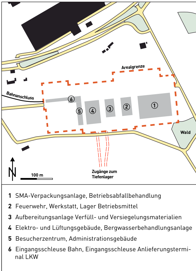
Bild 3: Mögliche Anordnung der Anlagenteile
