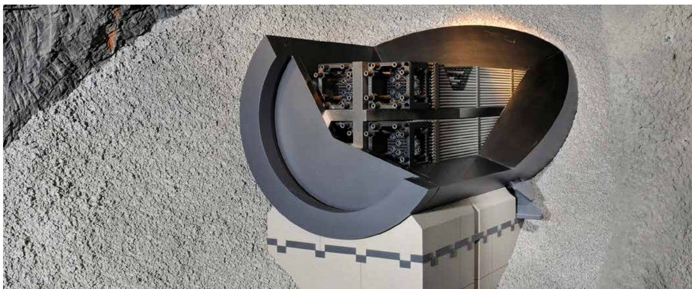
Il modello di un cunicolo di deposito per scorie altamente attive in scala 1:1. Si riconosce chiaramente la sezione del fusto d'acciaio che contiene gli elementi di combustibile. È possibile vedere questo modello in occasione delle visite guidate al laboratorio sotterraneo del Grimsel (BE) o a quello del Mont Terri (JU). Fotografia: © Comet Photoshopping, Dieter Enz
