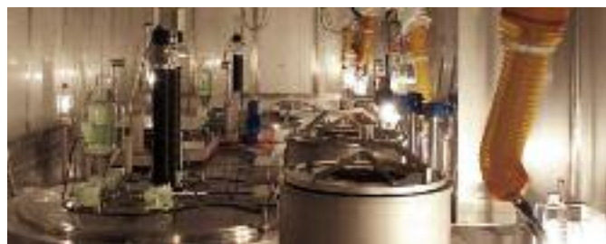
Partie de la cellule chaude de ZWILAG à Würenlingen où les éléments combustibles usés sont déchargés. (Photo ZWILAG)
