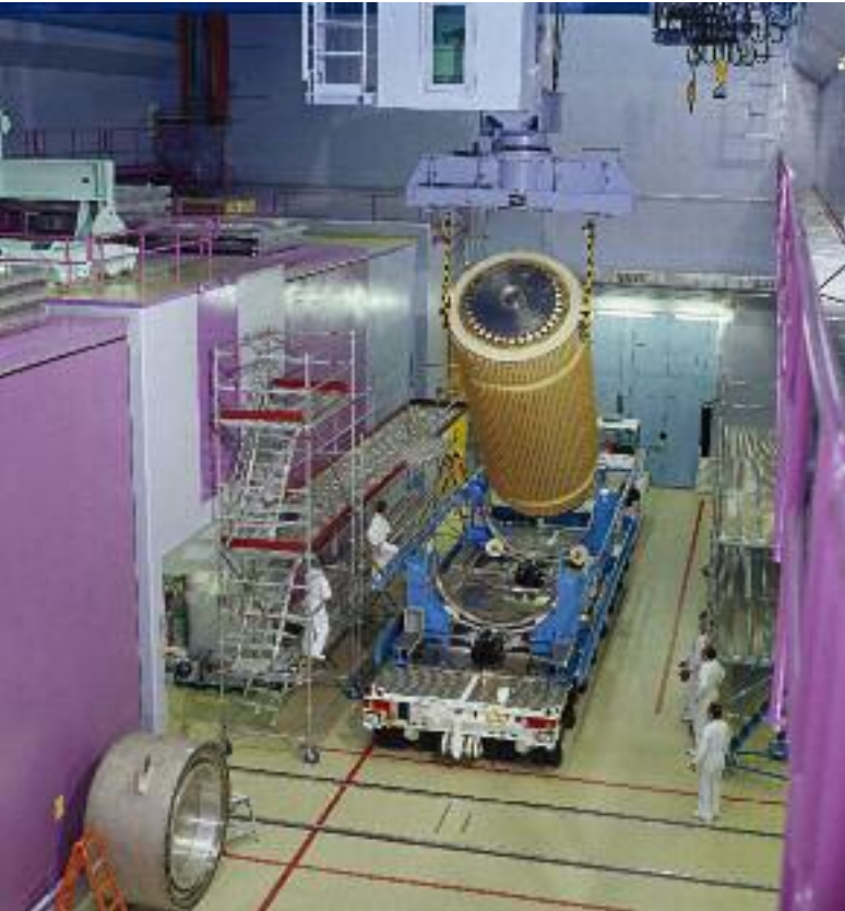
Transbordement à ZWILAG d'un conteneur de transport avec déchets de haute activité. (Photo COMET)
