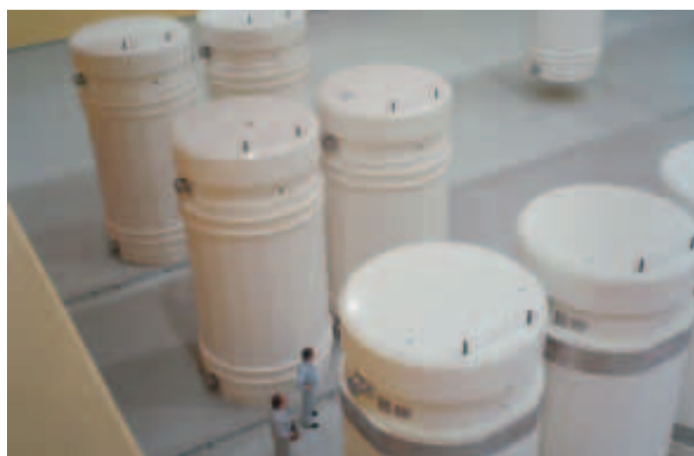
Le centre de stockage intermédiaire de Würenlingen (ZWILAG) abrite actuellement 22 conteneurs de dépôt avec assemblages combustibles usés et 8 conteneurs avec déchets de haute activité vitrifiés. (Photo ZWILAG)
