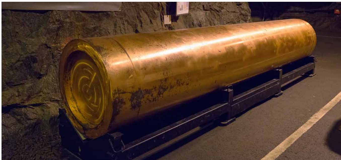
Le cuivre est le matériau que le concept suédois du stockage en profondeur prévoit pour les conteneurs de dépôt final. On discute actuellement de la stabilité du cuivre sur de longues périodes, dans des conditions de dépôts profonds. Photo: TRM
