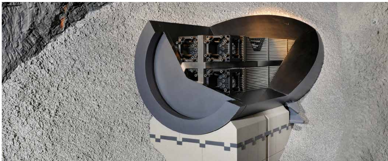
Modèle d'une galerie de stockage des déchets de haute activité à l'échelle 1:1. On voit bien le conteneur en acier découpé qui enferme les éléments combustibles. Les visites guidées du Laboratoire souterrain du Grimsel (BE) ou du Laboratoire souterrain du Mont Terri (JU) permettent de voir ce modèle de près. Photo: Comet Photoshopping, Dieter Enz
