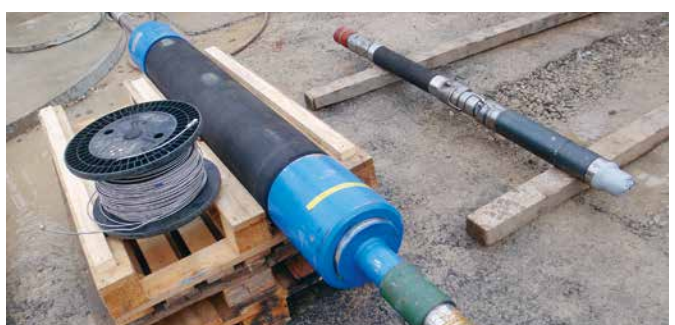
Packer vor ihrem Einsatz zwecks Abdichtung eines Bohrloches. (Foto: Nagra)
