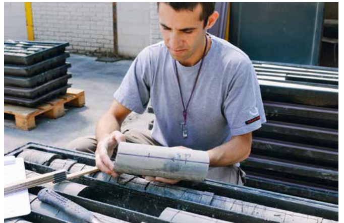
Ein Geowissenschaftler vermisst und dokumentiert einen frisch gezogenen Bohrkern auf dem Bohrplatz. (Foto: © Comet Photoshopping, Dieter Enz)
