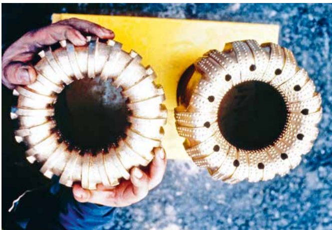
Damit Geologen Bohrkern erhalten, kommen Bohrkronen zum Einsatz. Sie fräsen sich in das Gestein und hinterlassen in der Mitte den Bohrkern (Foto: © Comet Photoshopping, Dieter Enz)
