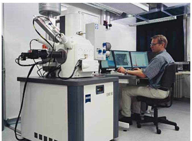
Laborarbeit mit Gesteinsproben aus einer Bohrung: Ein Wissenschaftler der Universität Bern untersucht mit einem Rasterelektronenmikroskop den Opalinuston. (Foto: © Comet Photoshopping, Dieter Enz)
