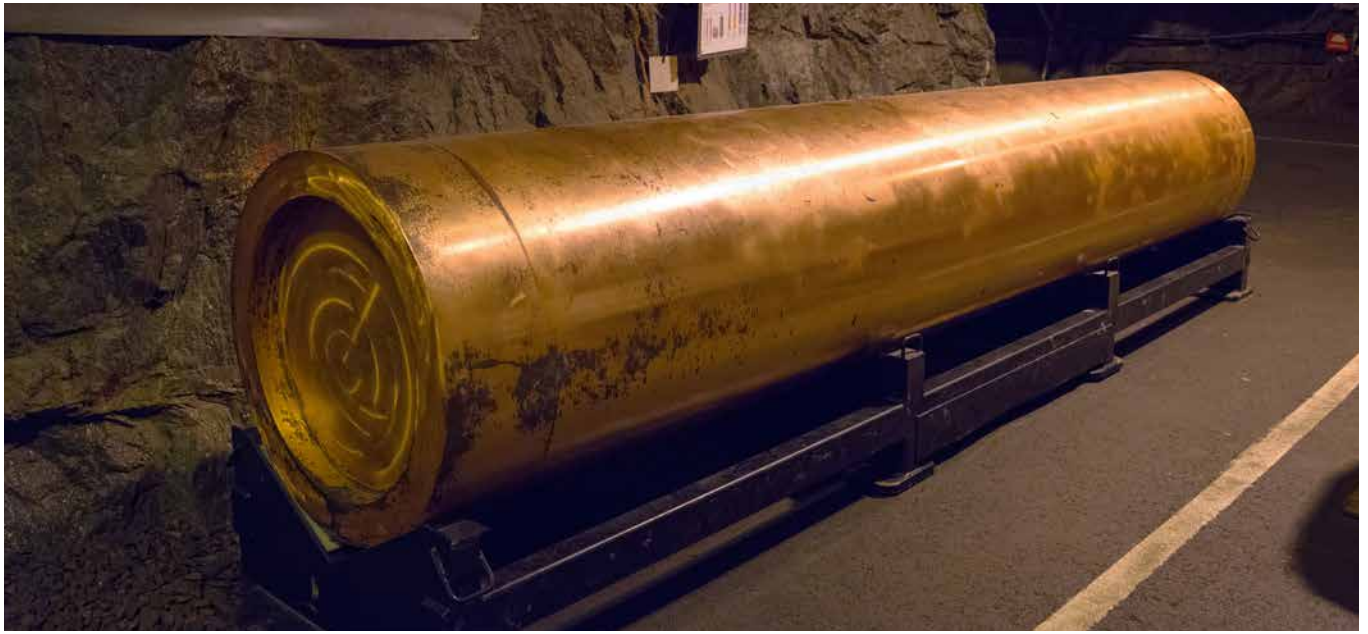
Das schwedische Konzept zur Tiefenlagerung sieht Kupfer als Material für die Endlagerbehälter vor. Die Stabilität von Kupfer unter Tiefenlagerbedingungen über lange Zeiträume wird aktuell diskutiert. Foto: TRM
