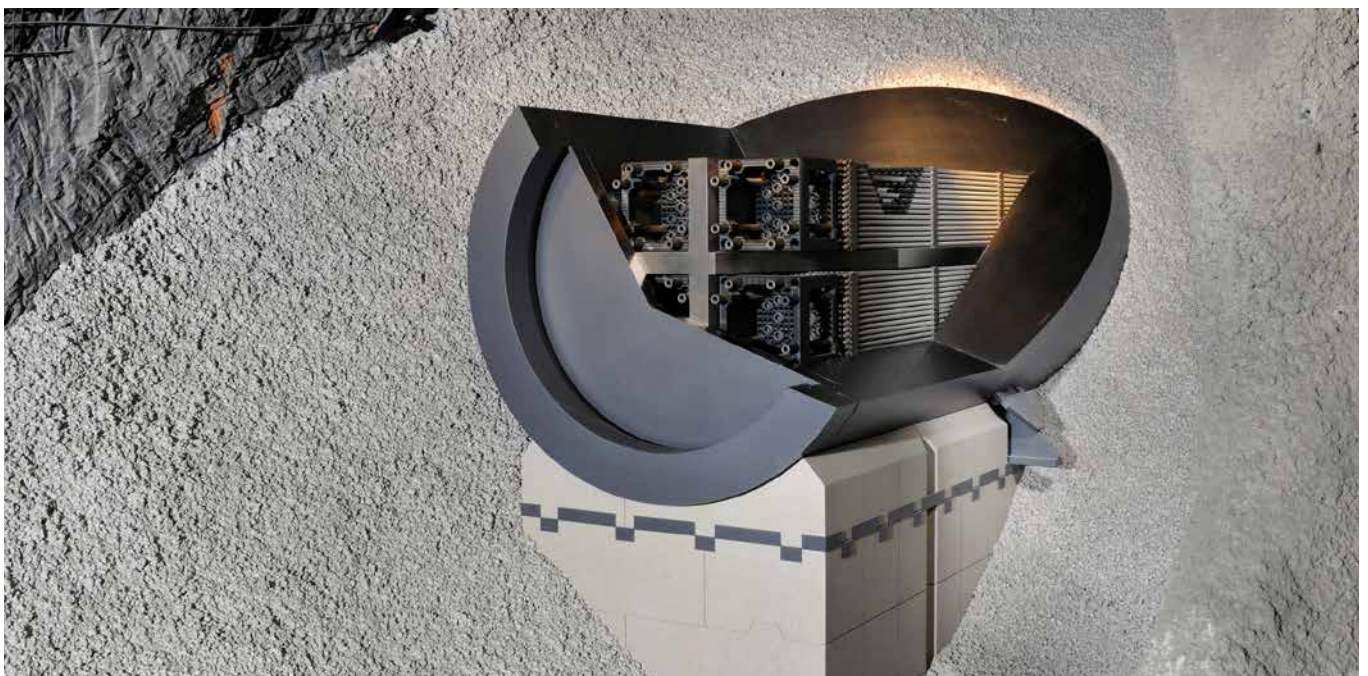
Das Modell eines Lagerstollens für hochaktive Abfälle im Massstab 1:1. Gut zu erkennen ist der aufgeschnittene Stahlbehälter, welcher die Brennelemente umschliesst. Dieses Modell kann bei Führungen im Felslabor Grimsel (BE) oder Felslabor Mont Terri (JU) besichtigt werden. Foto: © Comet Photoshopping, DieterENZ
