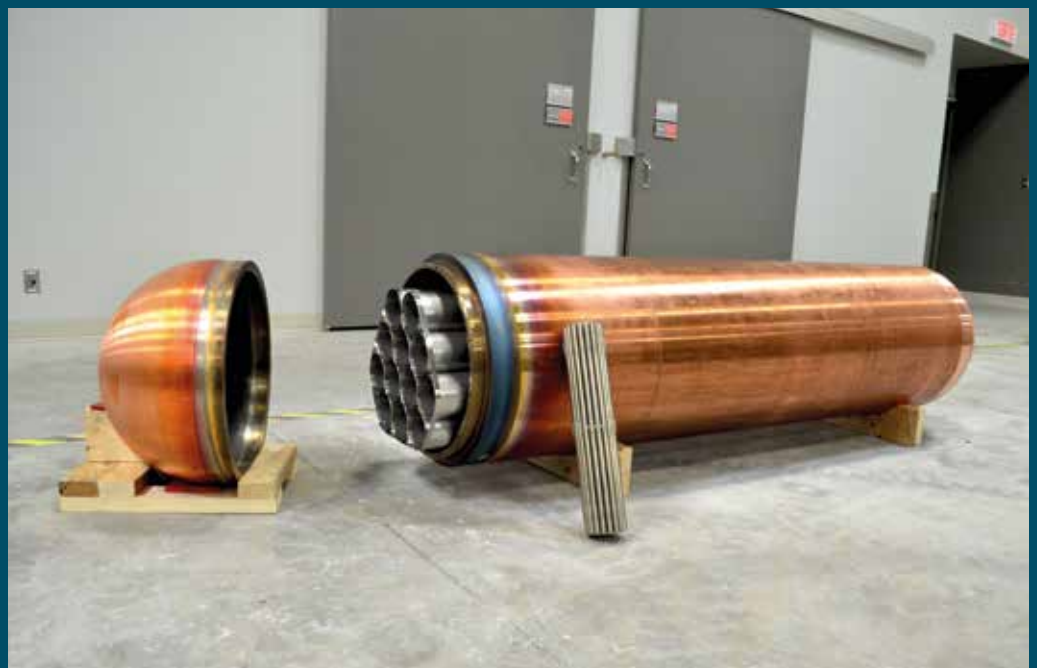
Prototype d'un conteneur en acier avec revêtement en cuivre
