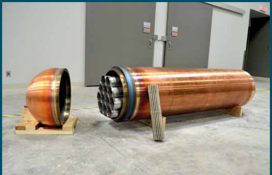
Prototyp eines Stahlbehälters mit Kupferbeschichtung
